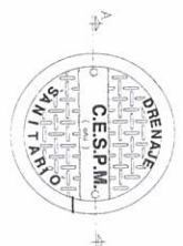
PLANTA IAPA DE HIERRO FUNDIDO
